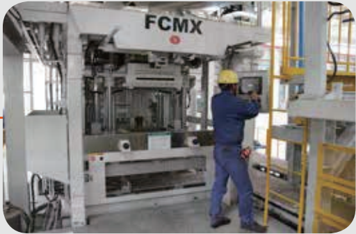
日本新东水平造型线 Sinto FCMX
