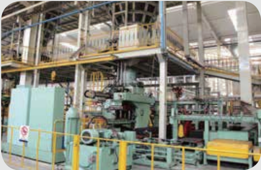
日本东九水平造型线 Tokyu AMF-111055
